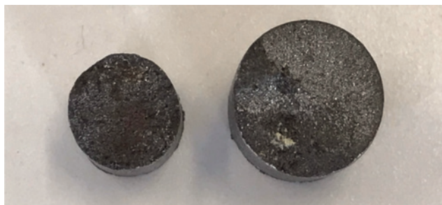
Рис. 1. «Темные пятна» в структуре образцов чугуна ВЧ 50
