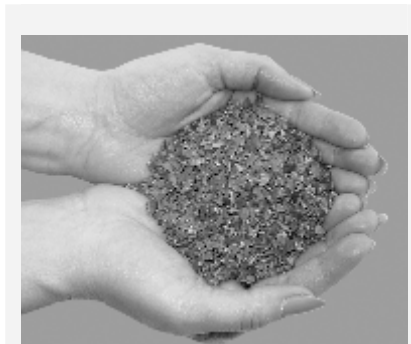
Рис. 1. Внешний вид микрокристаллического модификатора
