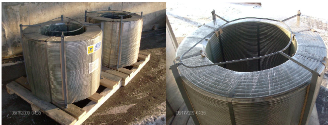
Рис.6. Вид поставляемых бобин порошковой проволоки
