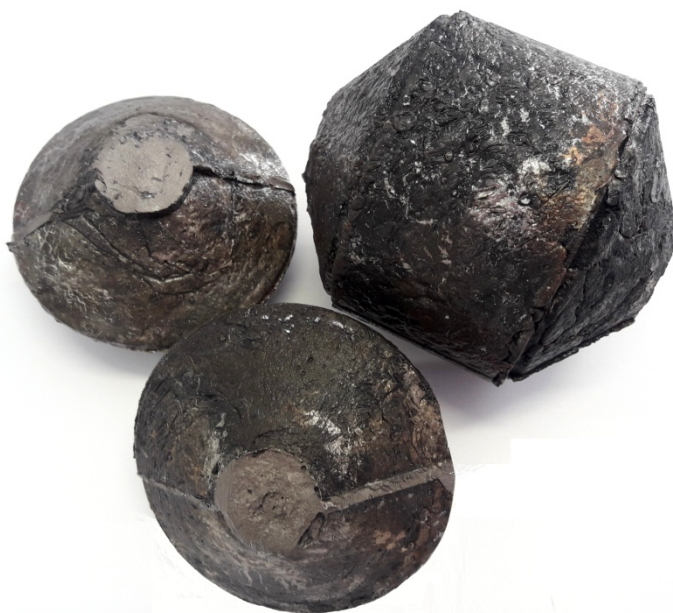
Мерные слитки лигатуры Сферомаг ® 5ФН
