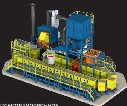
Автоматизированная формовочная линия (производительность до 600 т/месяц)
