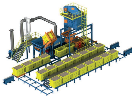
Механизированная формовочная линия (производительность до 100 т/месяц)
