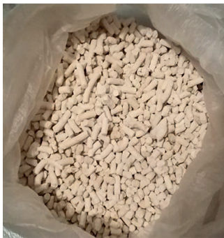
Рис. 4. Внешний вид модификатора для разупрочнения жидкостекольных смесей
