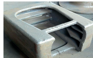
Рис. 5. Отливка мульда , изготовленная в форме из ПЖС с модификатором комплексного действия
