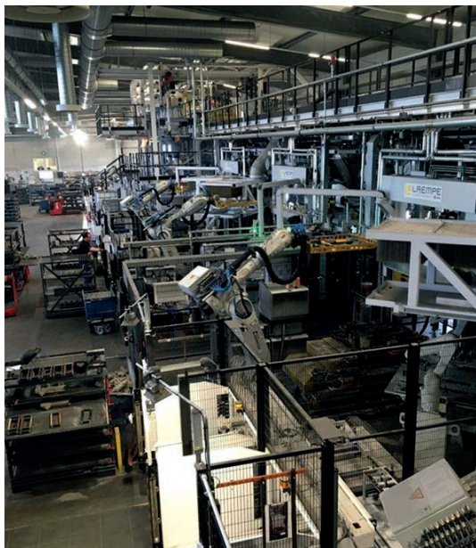
Рис. 5. Фрагмент автоматизированного стержневого участка Лаэтре для производства стержней по Veach Vox-процессу на немецком заводе Inacore в г. Энголдсбах (Бавария)
