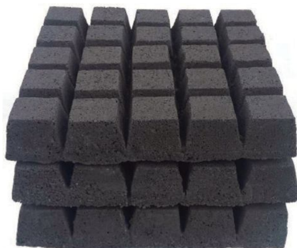
Рис. 8. Формованные брикеты для модифицирования в чаше формы
