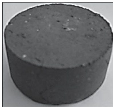
Рис. 2. Прессованный брикет для модифицирования в чаше формы
